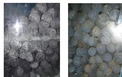
Gambar 3. Hasil dari Proses Seeding dan Aklimatisasi pada Media bioball
