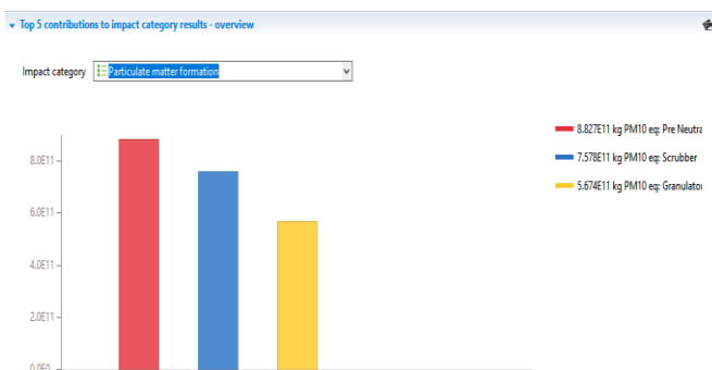
Gambar 5. Hubungan antara impact kategori particulate matter formation dengan unit proses produksi pupuk NPK
