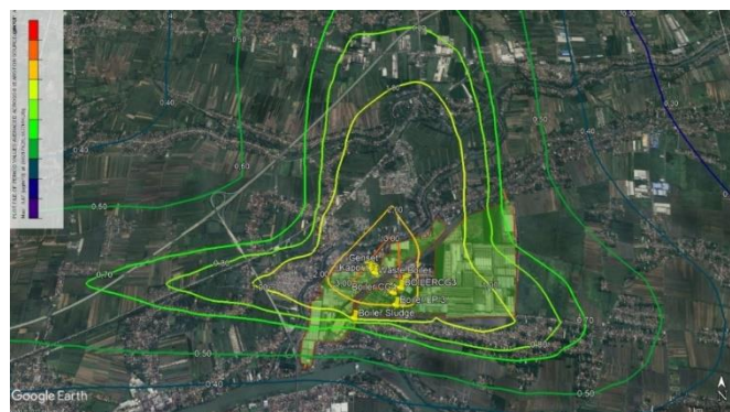
Gambar 4. Overlay Sebaran SO 2 Rata-Rata Sepanjang Tahun
