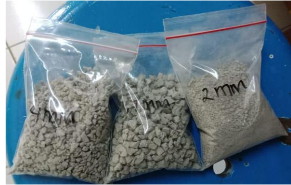
Gambar-3. Hasil ayakan dengan ukuran 2 mm, 4 mm dan 4,7 mm
