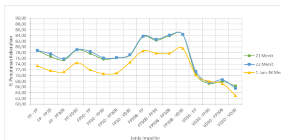
Grafik -4: Hubungan Jenis Impeller Koagulasi – Flokulasi Terhadap % Penurunan Kekeruhan Pada Setiap Waktu Pengadukan Koagulasi – Flokulasi
